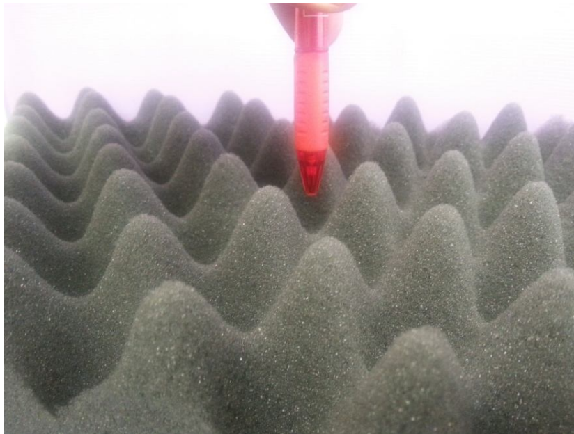
Figura 1. Mediante el uso de una superficie ondulada y una varilla o bolígrafo se ilustra el funcionamiento de un Microscopio de Efecto Túnel (STM).
