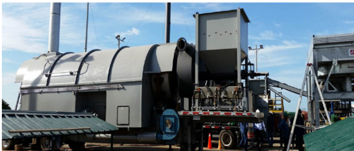
Figura 7. Unidad de desorción térmica (UDT) de la planta TECECOR.
